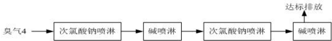
图 4.1-5 臭气 4（老污水站臭气）处理流程图
